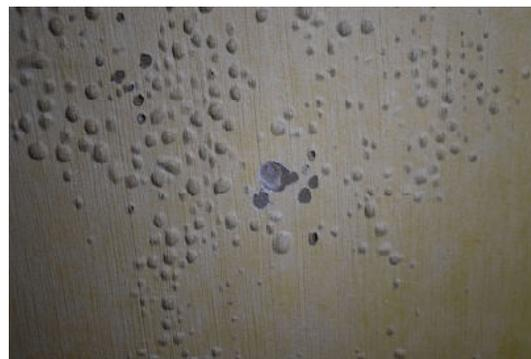
Luftblasen (Beschichtung Wasserkammer)
